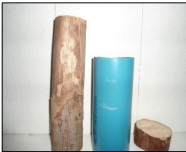
ภาพที่ 1 โครงสร้างเครื่องมือวัดแ่งประกอบด้วยไม้อัดกระบอกท่อพีวีซี (เส้นผ่านศูนย์กลาง 3 นิ้ว สูง 5.5 นิ้ว) และฐานของกระบอก (สูง 1.5 นิ้ว)
